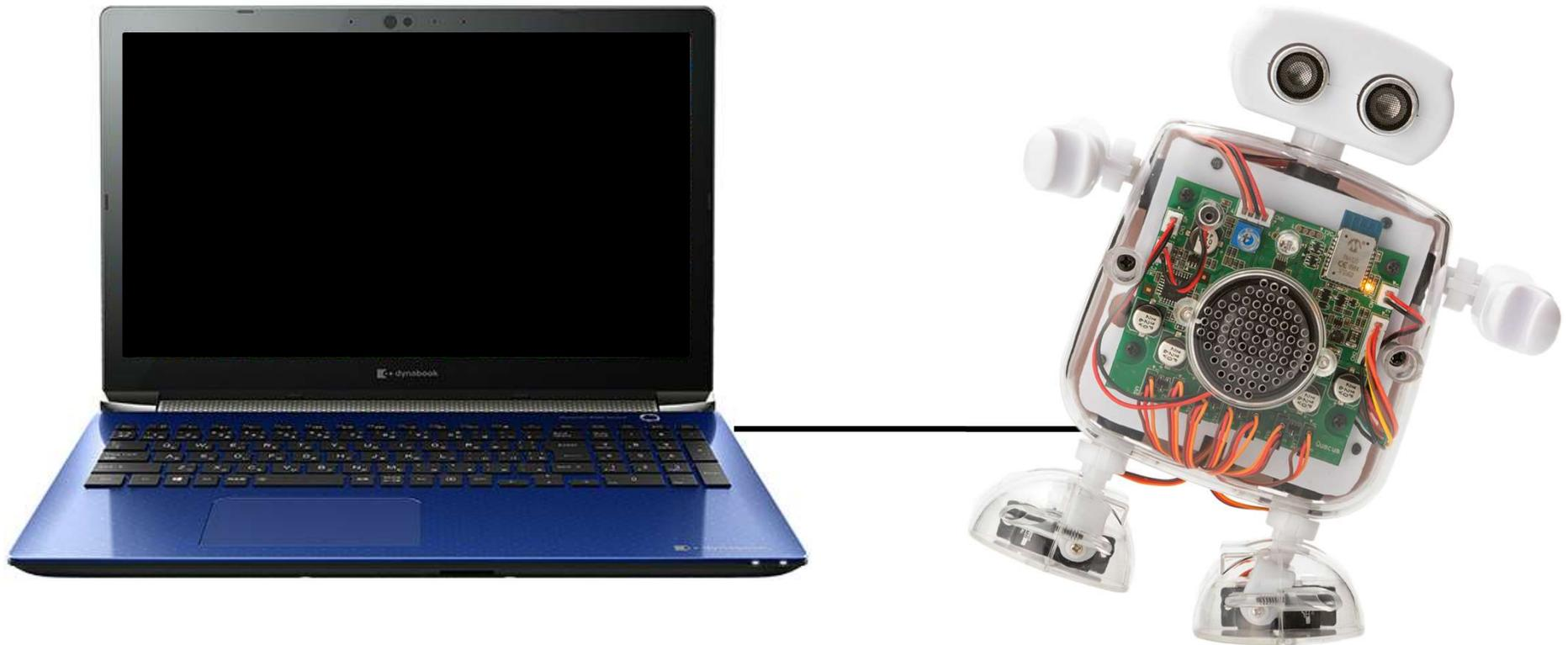
USBケーブルでパソコンとロボットを直接接続します。
