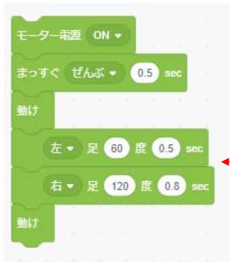
左と右のモーターを同時に動かして傾きを作る。
