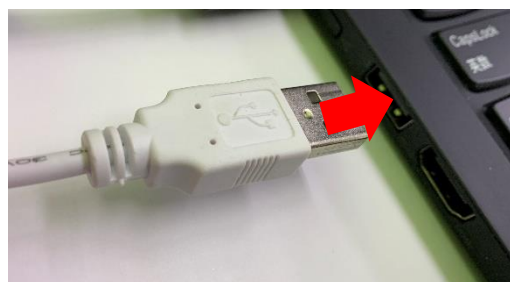
USB コネクタ TypeA(オス)を PC の USB ポート TypeA(メス)に接続します
