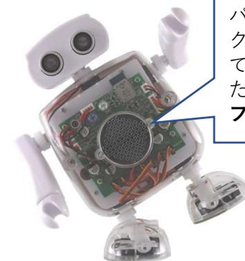
パソコンから送られてくるスクラッチのコマンドを解析してクムクムのパーツを動かすためのロボット側のソフトを**ファームウェア**と言います
